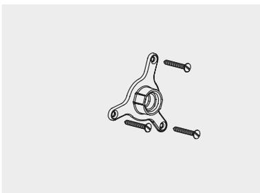
7. Remettre en place l'applique et la fixer grâce aux vis fournies.
