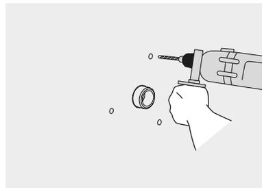
5. Retirer l'applique et percer le mur au niveau des marques.
