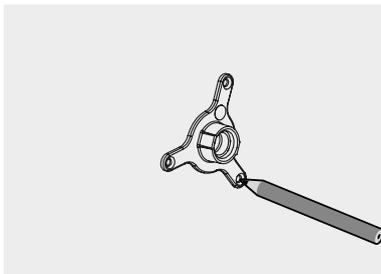
4. Plaquer l'applique sur le mur et marquer les emplacements à percer à l'aide d'un crayon.
